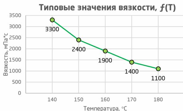
В периоды простоя оборудования необходимо снижать температуру нагрева клея-расплава, в случае длительной остановки работы – выключать нагрев во избежание термической деструкции клея.
