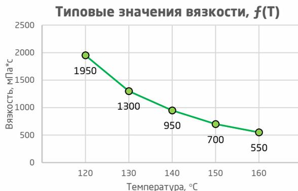
В периоды простоя оборудования необходимо снижать температуру нагрева клея-расплава, в случае длительной остановки работы – выключать нагрев во избежание термической деструкции клея.
