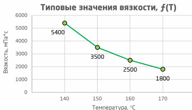
В периоды простоя оборудования необходимо снижать температуру нагрева клея-расплава, в случае длительной остановки работы – выключать нагрев во избежание термической деструкции клея.
